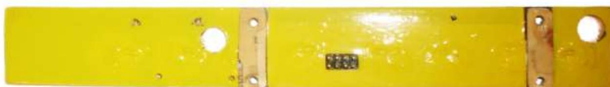
***Base de madera con soportes y conector para los electrodos***
